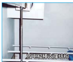
放电极棒支撑结构
